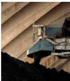
Точный контроль уровня в запыленных бункерах? Узкий конус луча SITRANS LR560 обеспечивает простоту измерения уровня в условиях сильной запылённости.
